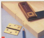
1 Разметку под выборку делают по соответствующей карте петли, используя угольник. Место прорезки не должно показывать на шпунт.
